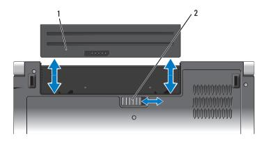
loquet de fermeture de batterie 1 batterie 2
